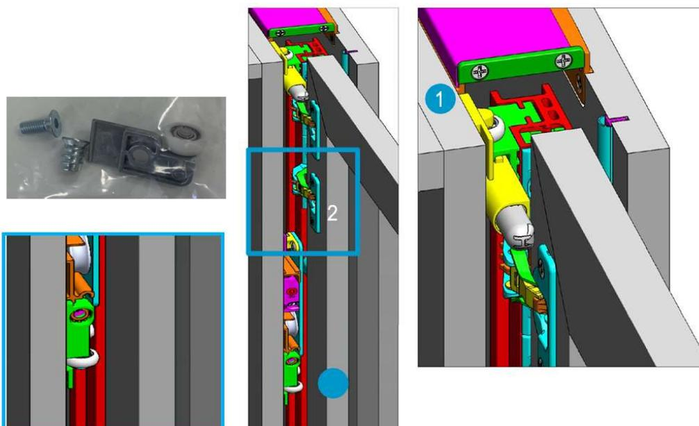
2. Les roues supplémentaires doivent être installées sur la partie supérieure et inférieure du cabinet. Cela sert également de clip pour le cache mécanisme en PVC.
