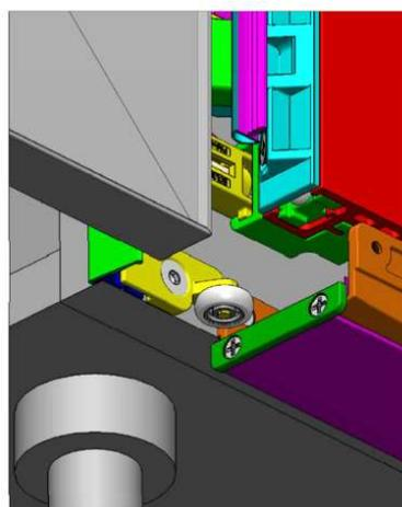
3. Pour l'installation de la roue supplémentaire, le fournisseur coupe le poteau avant de 28 mm plus court sur la partie supérieure et inférieure de l'armoire.
